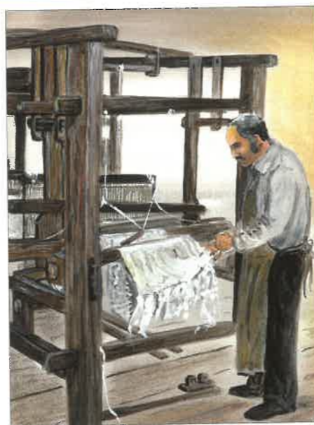
Práce na domácím tkalcovském stavu. Tento způsob domácí výroby byl v továrnách nahrazen mechanizovanými tkalcovskými stavy.
